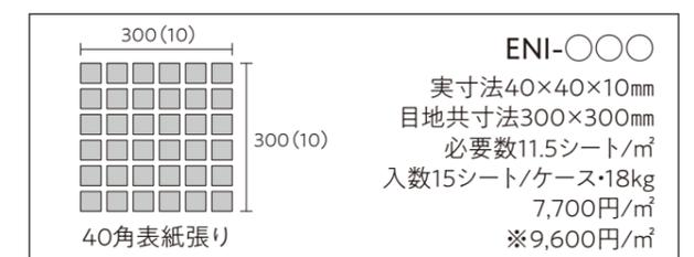
■目地残りのり残りに注意してください。 ■目地は10mmに設定してあります。 ■ミックスによる色幅と土物特有の大きな色幅がある製品です。 ■※印は割増価格です。また、注文を受けてから加工しますので納期をご確認ください。
