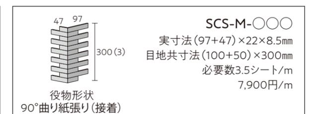
■接着剤張り専用商品です。弾性接着剤をご使用ください。 ■形状・寸法にバラツキがあります。 ■焼物特有の自然な色ムラと色幅があります。 ■この商品は濃・淡の2色ミックスです。(100以外) ■紙剥がし後の水洗いを必ず行い、糊を除去したうえで目地施工を行ってください。 ■黒目地をご使用の場合は目地残りによる汚れにご注意ください。
