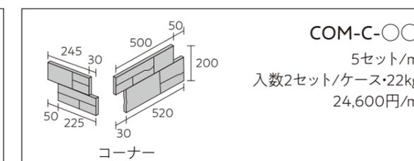
■剥離防止、汚れ防止のため施工後に撥水加工をしてください。 ■サンプルと納品品、フラット、コーナーとは色差が生じることがあります。 ■施工前に必ず数ケースを仮置きして、色合いを確認してください。 ■酸洗いは避けてください。 ■水がかかる場所でご使用の場合は、裏面に水が廻らないように目地増をしてください。 ■施工は接着剤又はポリマーセメント(2剤混合タイプ)にて、躯体とパネル裏面全体に隙間なく行き渡るように行ってください。 ■剥がれや角欠けがある場合は、割口を合わせてご利用ください。 ■施工の際、パネルとパネルのジョイント部分は、木片等を用いてスペースを確保してください。 ■屋外へご使用の場合は、隙間に目地を注入して、裏面に水が侵入しないようにしてください。 ■腰高以上の高さへの施工は、金具を併用する等の落下防止策をとってください。 ■施工後のクレームはお受けできませんのであらかじめご了承ください。
